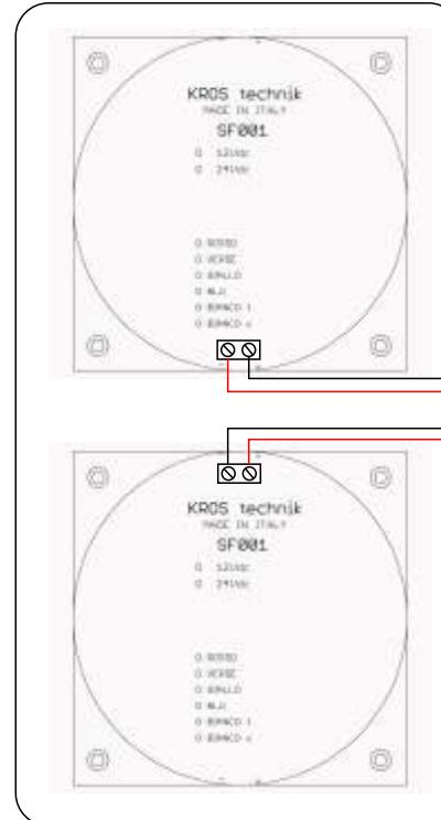
Su ogni scheda elettronica è indicato il tipo di voltaggio ed il colore dei led montati su di essa.
