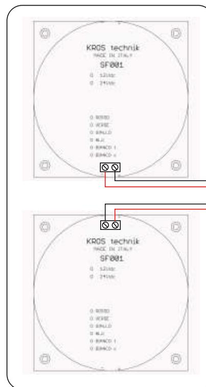
Su ogni scheda elettronica è indicato il tipo di voltaggio ed il colore dei led montati su di essa.
