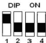
Di serie i DIP di programmazione vengono impostati come in figura
