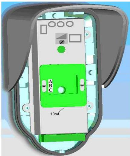
Installare il sensore ad una altezza massima di 2,3 mt ,ideale a 2,1 mt
